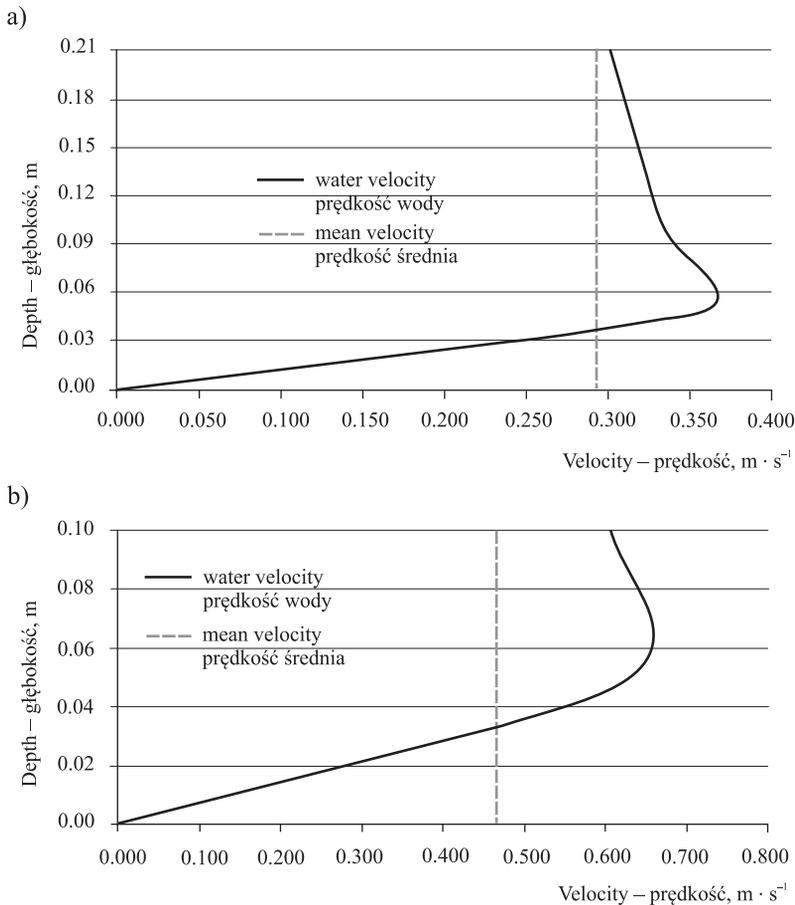
Rys. 6. Prędkości wody w pionie oraz prędkość średnia w szczelinie przegrody: a) nr 2, b) nr 10
