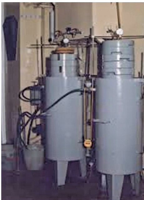
Ryc. 1. Aparaty średniowymiarowe do badań współczynnika filtracji (fot. A. Owskiński)
