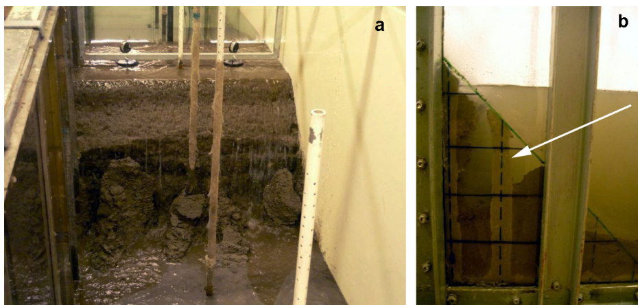
Ryc. 6. Efekt finalny przelania się wody przez koronę modelu 4: a) widok od strony skarpy odpowietrznej, b) ubytek masy gruntu w widoku z boku
