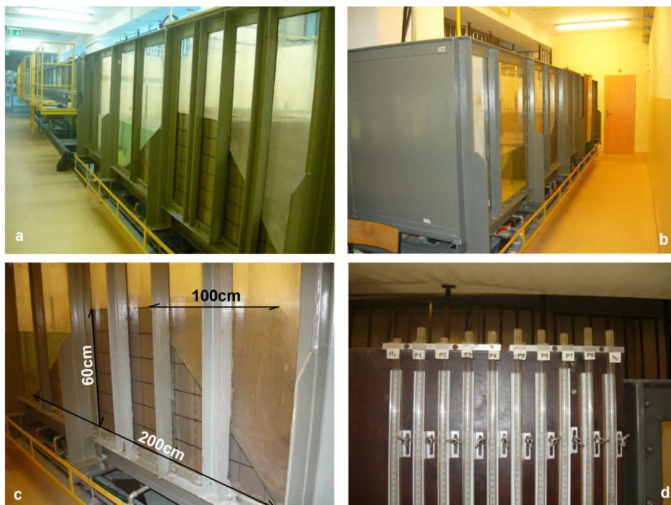
Ryc. 3. Ogólny widok stanowiska do badań modelowych: a), b) widok ściany czołowej, c) model nasypu z wymiarami, d) tablica pomiarowa poziomów wody
