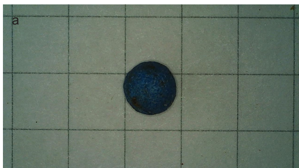
Ryc. 10. Przykłady mikrogranulek plastiku a) okrągły element zabawek, b) kulki styropianu; kratka 5 × 5 mm (Autor: Ewa Dacewicz)
