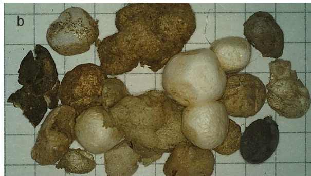
Ryc. 10. Przykłady mikrogranulek plastiku a) okrągły element zabawek, b) kulki styropianu; kratka 5 × 5 mm (Autor: Ewa Dacewicz)
