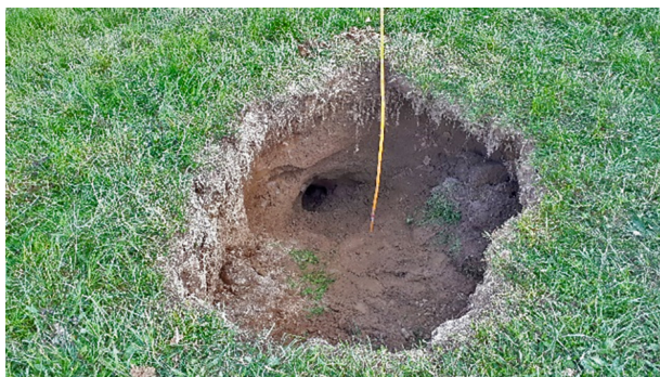
d) kanał sufozyczny – piping channel
