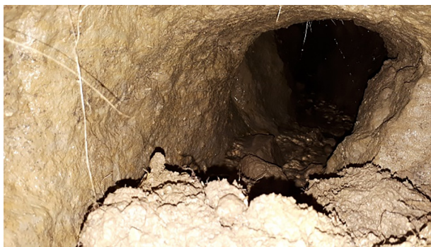
d) kanał sufozyczny – piping channel
