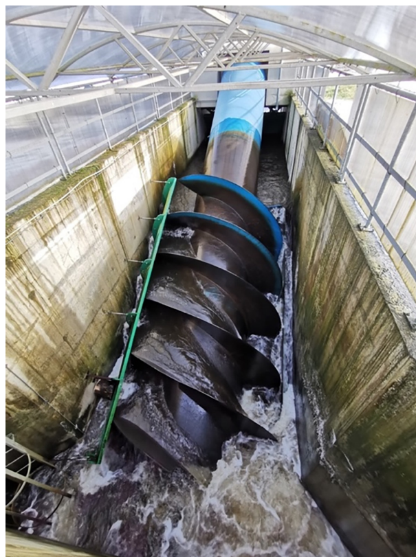
Ryc. 3. MEW Zawadzkie na rzece Mała Panew – widok na komorę turbiny (fot. M. Dziedzic)
