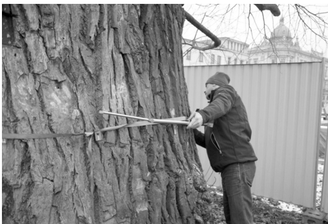
Ryc. 3. Pomiar geometrii pnia drzewa za pomocą suwmiarki PiCUS Calliper (M. Dudkiewicz 2016)
