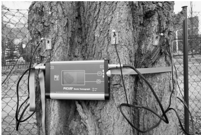
Ryc. 2. Tomograf soniczny ułożony na pniu drzewa (W. Durlak 2016)
