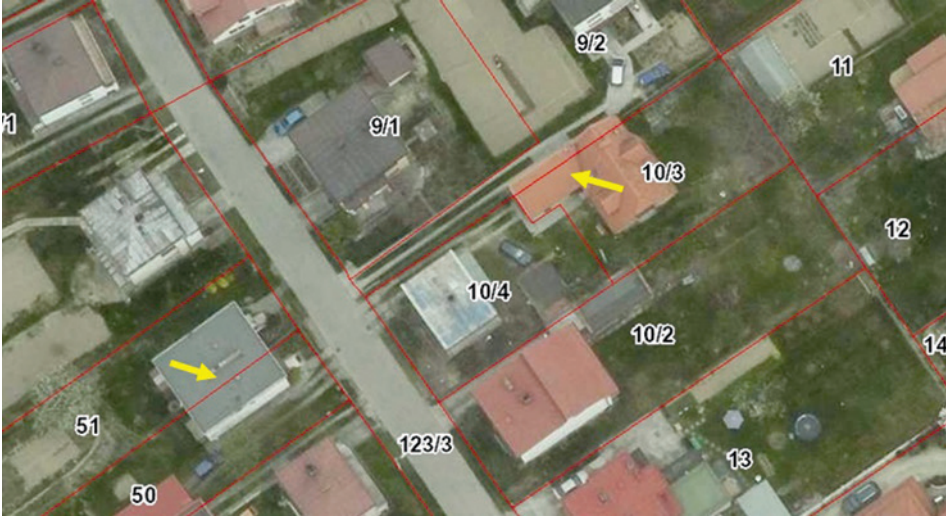
Ryc. 2. Przykład kolizji granic ewidencyjnych z budynkiem
